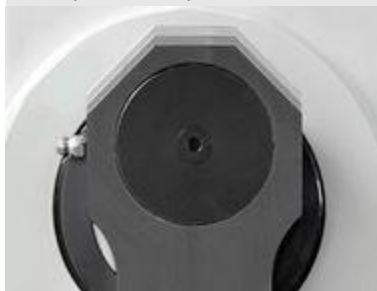
Ajustement hauteur de sertissage
