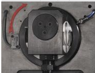
Excentrique de commande
