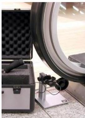
Le système à haute résolution de mesure **EBT**, associé à l'indicateur de vitesse P110, mesure la vitesse, la distance et le temps d'arrêt sur les escalators ou les courroies de convoyeur.
