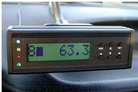
Le capteur de vitesse avec GPS **SAT100** est indépendant des conditions climatiques et de l'état de la route. La sortie numérique de fréquence et la sortie analogique de vitesse permettent une connexion à la plupart des systèmes d'acquisition de données. Liaison avec un ordinateur par Interface RS232.
