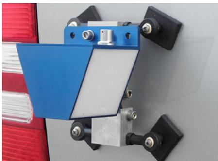
Le nouveau capteur-radar **GSS15** permet de relever une vitesse par rapport au sol, sans contact. La surface de la route est scannée par un radar à une fréquence de 24 GHz. Le processeur interne génère un signal de sortie TTL de grande qualité. Existe aussi en version haute précision.
