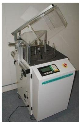
Une gamme de récupérateurs par lovage et linéaires en fonction des besoins de votre production. Les récupérateurs par lovage se distinguent par leur facilité d'utilisation et leur fiabilité en milieu industriel. Le diamètre d'enroulement va de 100 mm à 750 mm pour un poids maximal des couronnes de câbles de 80 kg.
