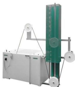
Une gamme complète de dérouleurs pour des poids de bobines allant jusqu'à 1000 kg et des diamètres jusqu'à 1260 mm. Les dérouleurs sont équipés avec des compensateurs linéaires ou des bras oscillants pour une synchronisation parfaite entre le dérouleur et la machine de coupe en aval.
