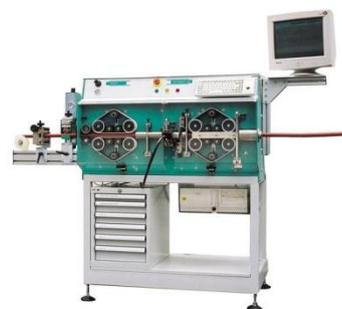
une unité de coupe hydraulique : les câbles les plus spécifiques, jusqu'à 35 mm de diamètre peuvent être débités et dénudés sans difficultés. Les paramètres de production sont gérés par ordinateur, permettant de mémoriser un nombre important de lots de production. La configuration de la machine avec des unités d'impression très proches des couteaux permet une production de tout petits lots quasi sans chutes. Une machine très robuste pour une production de très haut niveau.
